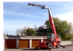
Auslegerverlängerung bis 22.00 m mit Winde 1.0t.
